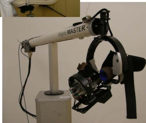
Robot HapticMASTER z napravo za prijemanje
