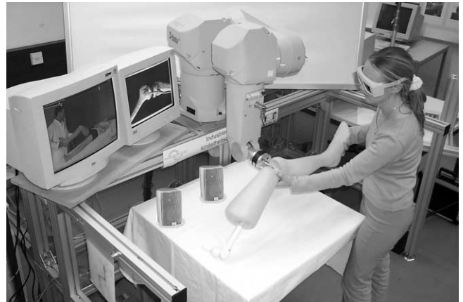
Bild 8: Multimodaler Trainingssimulator bestehend aus grafischem, akustischem und haptischem Display im Teaching Modus.
