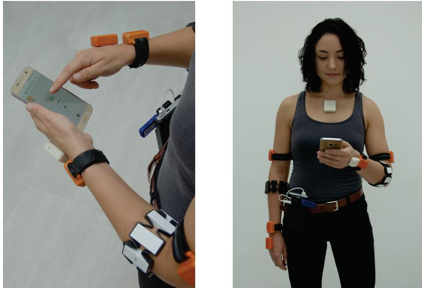
Slika 2.10: Nosljivi merilni sistem za dolgotrajne meritve in upravljanje aplikacije na mobilnem telefonu
