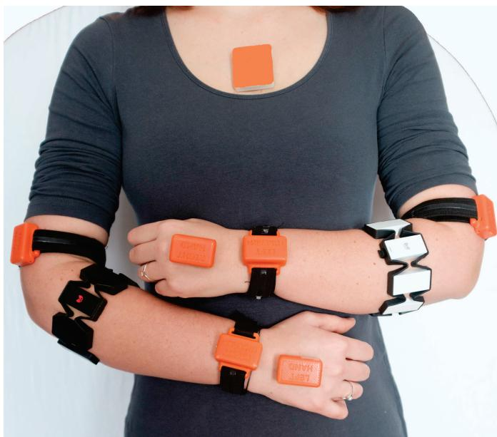
Slika 2.1: Merilni sistem z IME in zapestnicama EMG nameščen na zgornjih udih.
