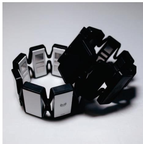
Slika 2.4: Zapestnici z osmimi EMG elektrodami za merjenje mišične aktivnosti na podlakti.
