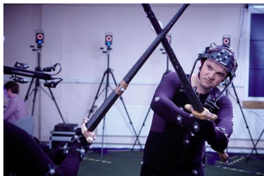
Optični merilni sistem Vicon za merjenje zgornjih okončin med vadbo
