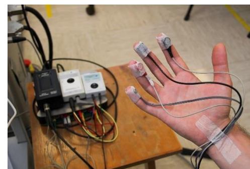
Referenčni merilni sistem g.USBamp (g.tec) in namestitev senzorjev
