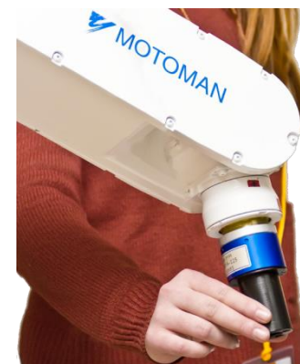
Celica za merjenje sile pritrjena na vrh robota
