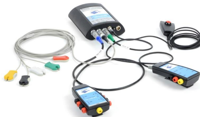
Komercialno dostopna ojačevalnika fizioloških signalov g.USBamp, g.tec
