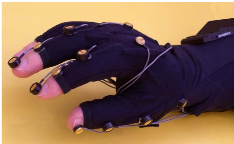
Slika 19. Umerjanje merilne rokavice DataGlove® s sistemom za optično sledenje Optotrak®.
