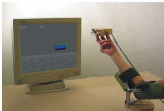
Slika 1. Eksperimentalno okolje za preučevanje koordinacije med podlahtjo, zapestjem in prsti.
